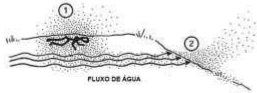
Figura 8: Ponto 1 cone de odor primário, ponto 2 cone de odor secundário distante da fonte devido a correnteza.
